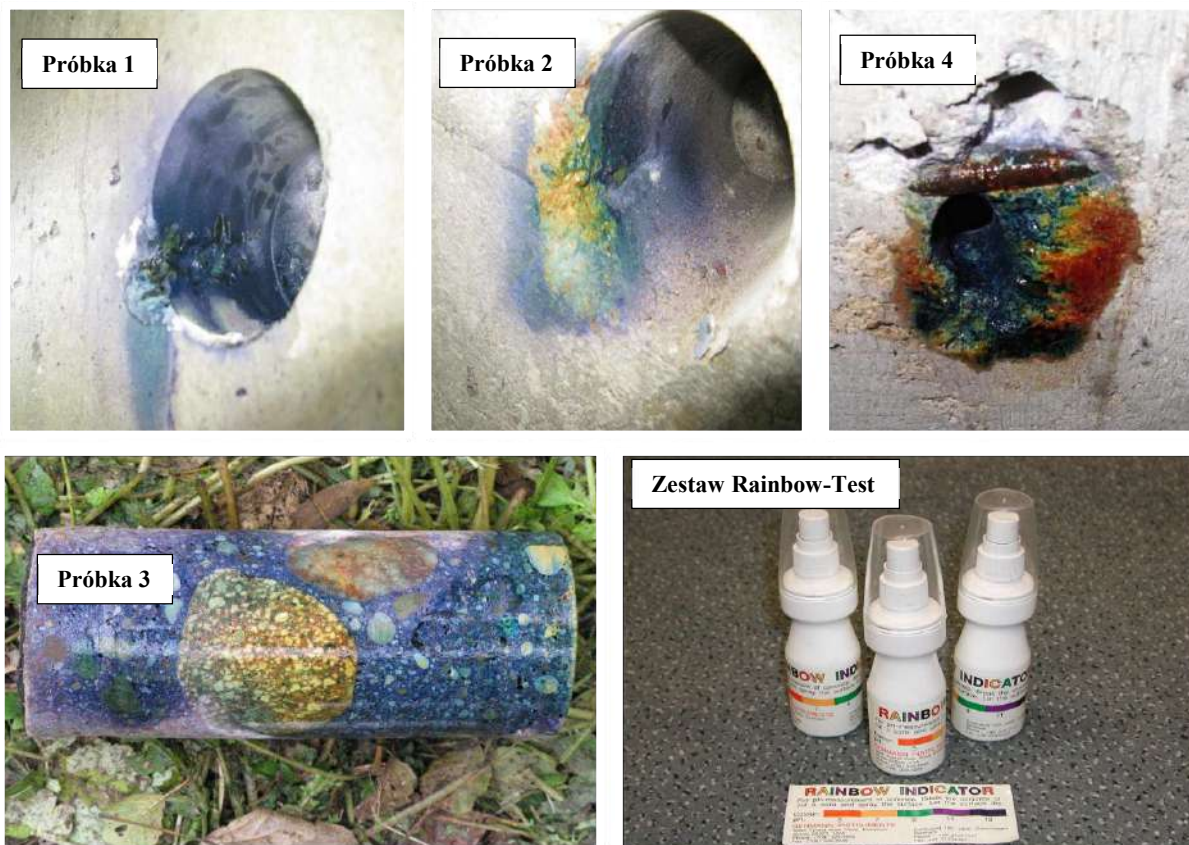
Rysunek 3.9. Wyniki badań chemicznych próbek oraz zestaw badawczy Rainbow-Test (Tarcopol, 2010).
