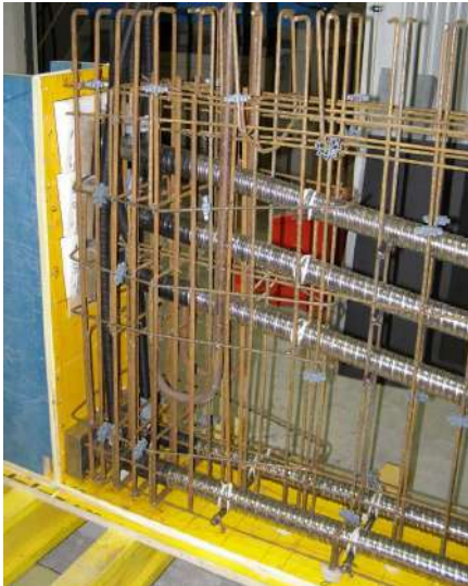
Rysunek 4.7. Przygotowanie szkieletów zbrojenia dźwigarów laboratoryjnych.
