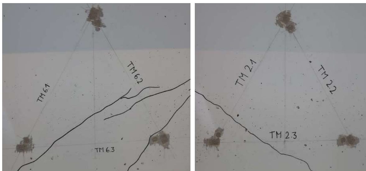
Rysunek 5.51. Porównanie zarysowania w obszarach pomiarów rozet.
