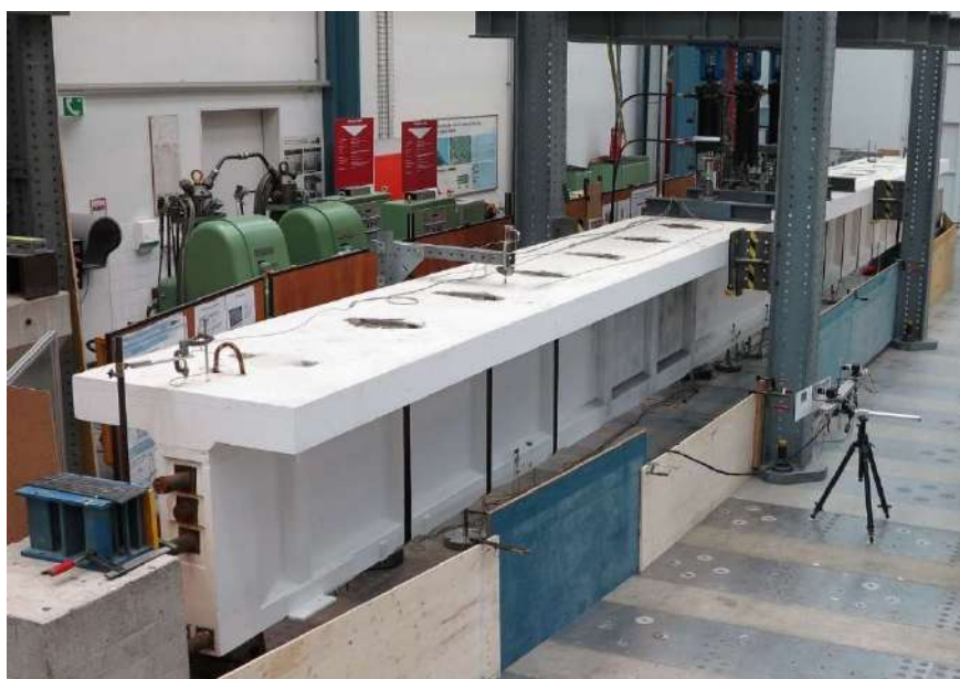
Rysunek 5.56. Dźwigar wzmacniony podczas badania nośności na zginanie.
