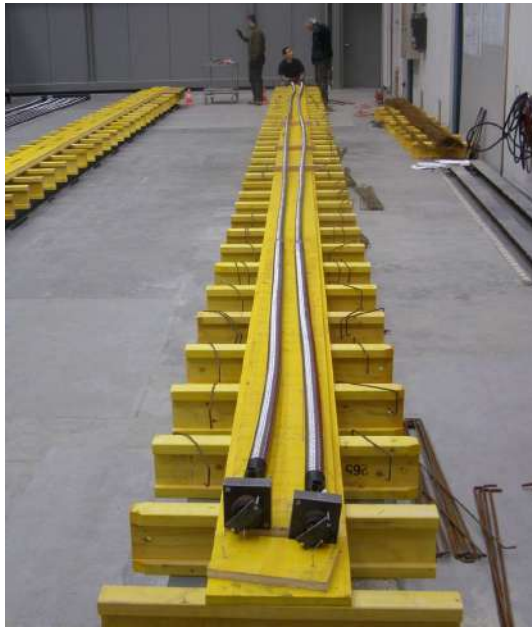
Rysunek 4.7. Przygotowanie szkieletów zbrojenia dźwigarów laboratoryjnych.
