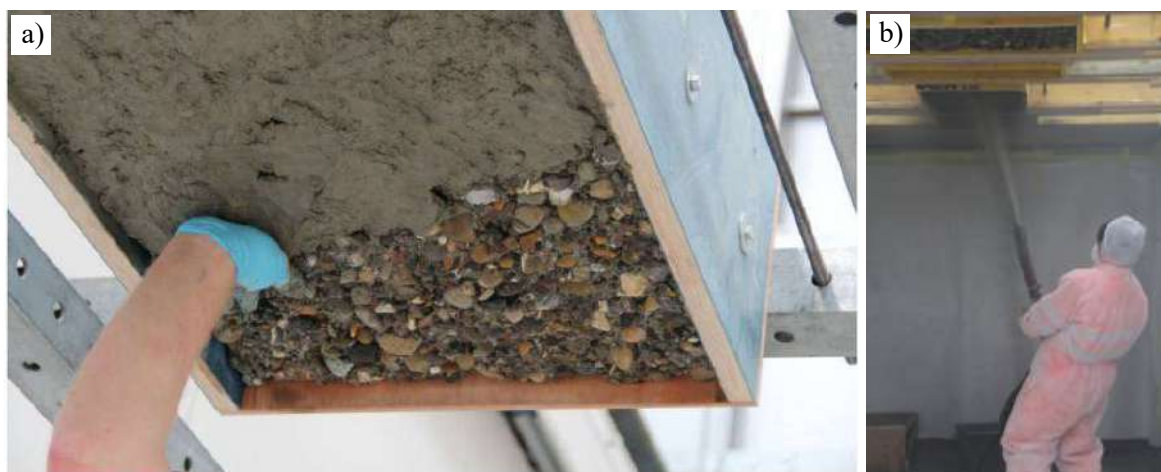
Rysunek 5.9. Przygotowanie próbek zapraw nakładanych ręcznie (a) oraz metodą torkretowania (b) w laboratorium EMPA (J. Michels).
