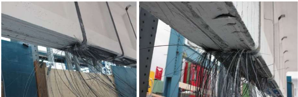
Rysunek 5.55. Widok zerwanych taśm kompozytowych, których odspojenie powstrzymały przez oploty mat CFRP.
