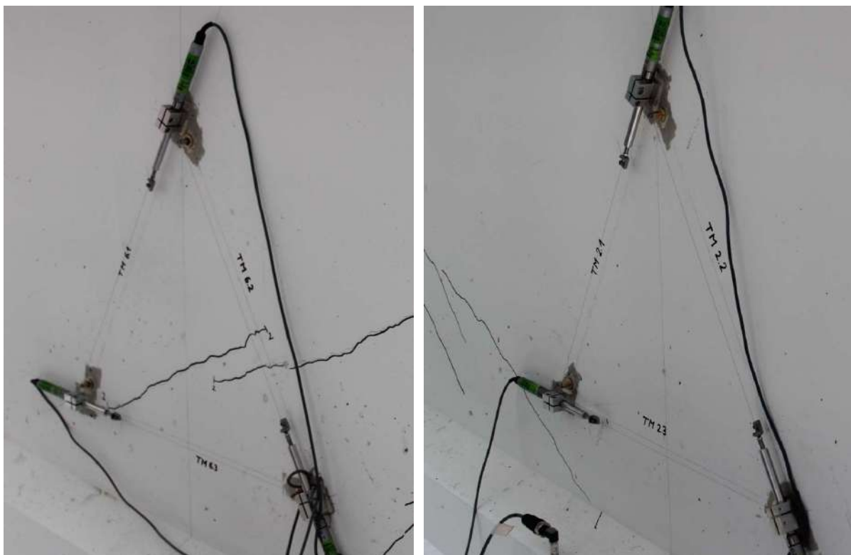
Rysunek 5.34. Porównanie zarysowania w obszarach pomiarów rozet.
