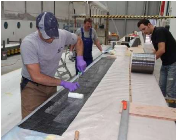
Rysunek 4.44. Impregnowanie i składanie odcinka maty CFRP na stole roboczym.
