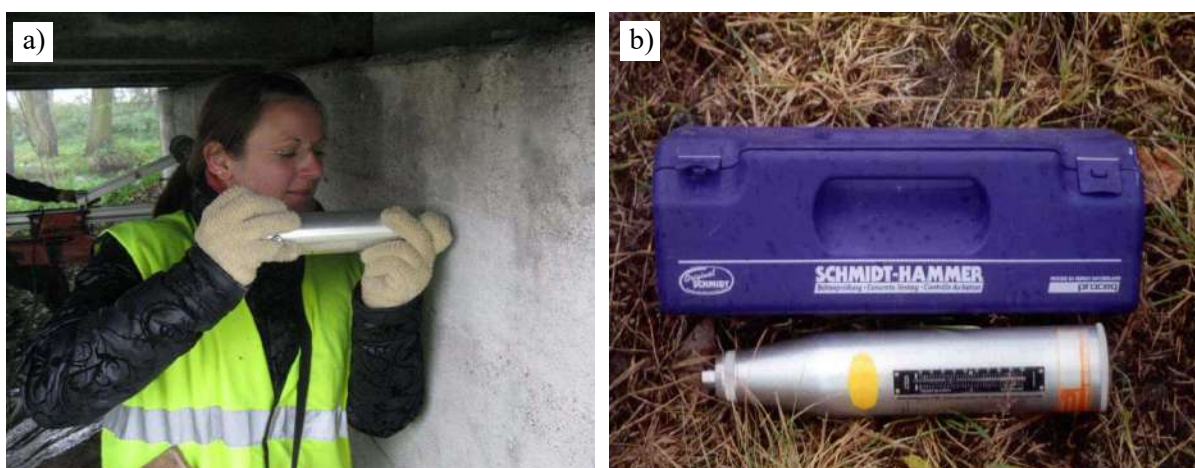
Rysunek 3.10. a) Przebieg badań sklerometrycznych, b) Młotek Schmidta użyty do badań (Tarcopol, 2010).
