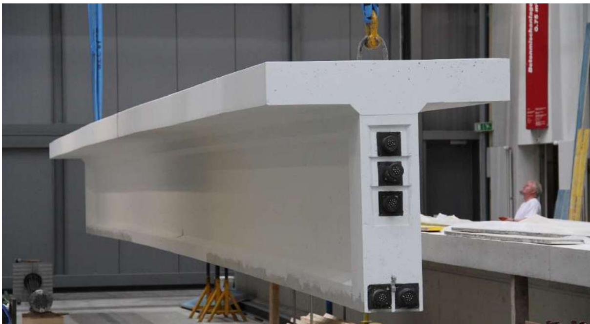
Rysunek 4.21. Widok dźwigara nr 1 po rozformowaniu.
