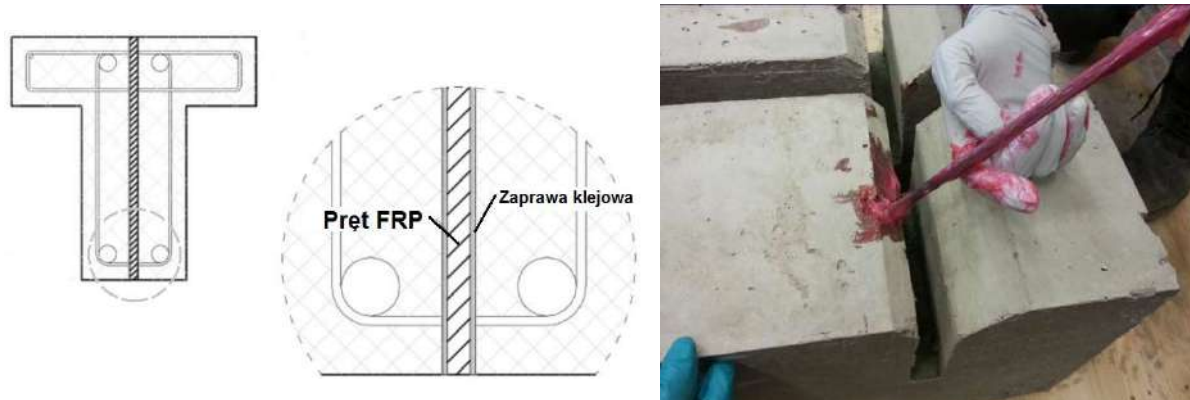
Rysunek 1.22. Schemat instalacji wzmocnienia typu ETS oraz przykładowa aplikacja (Racic i inni, 2016).
