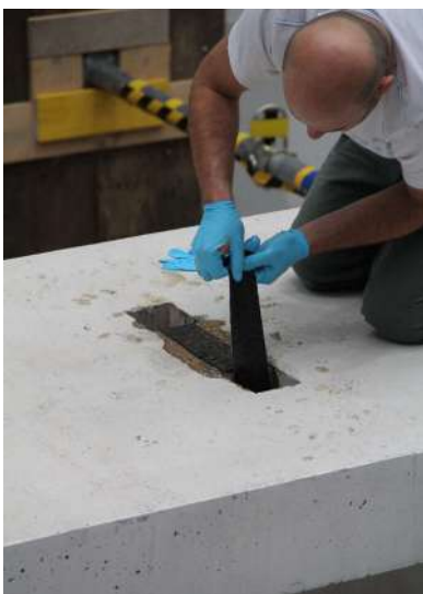
Rysunek 4.46. Łączenie końców mat CFRP na zakład na górnej powierzchni płyty.
