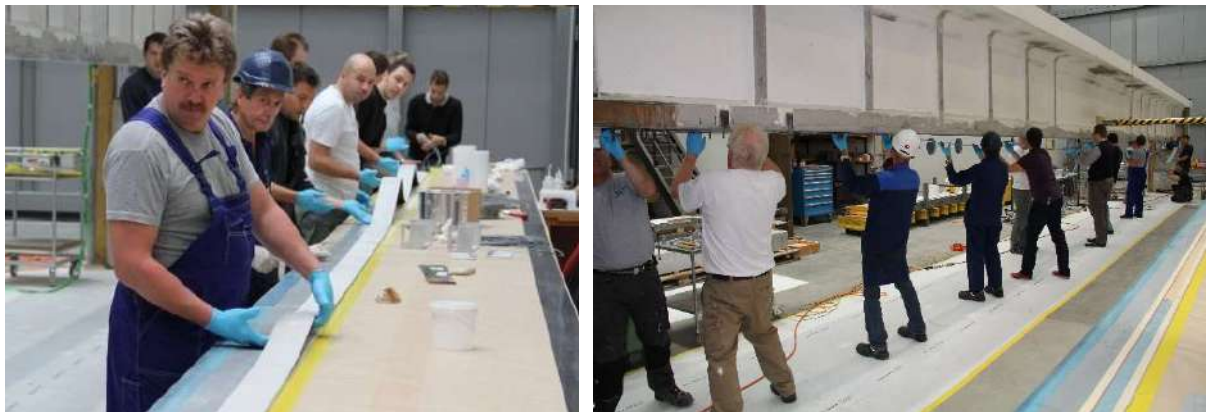
Rysunek 4.41. Przenoszenie taśmy z klejem na powierzchnię dźwigara.
