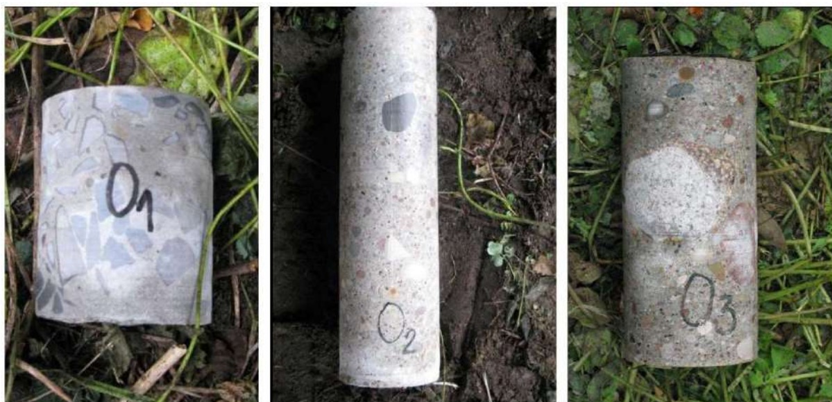
Rysunek 3.11. Odwierty do pobrania próbek do badań laboratoryjnych (Tarcopol, 2010).
