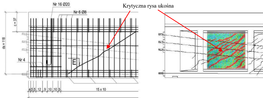
Rysunek 7.56. Określenie liczby strzemion przenoszących siłę poprzeczną w dźwigarze laboratoryjnym na podstawie obserwacji rysy krytycznej w badaniach.
