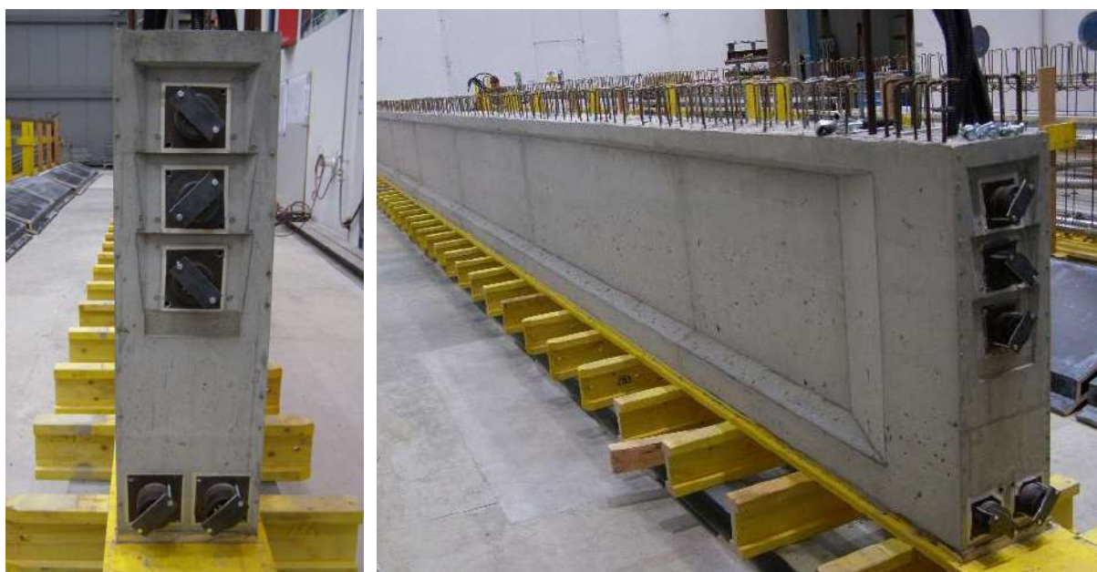
Rysunek 4.14. Widok dźwigara po rozformowaniu.
