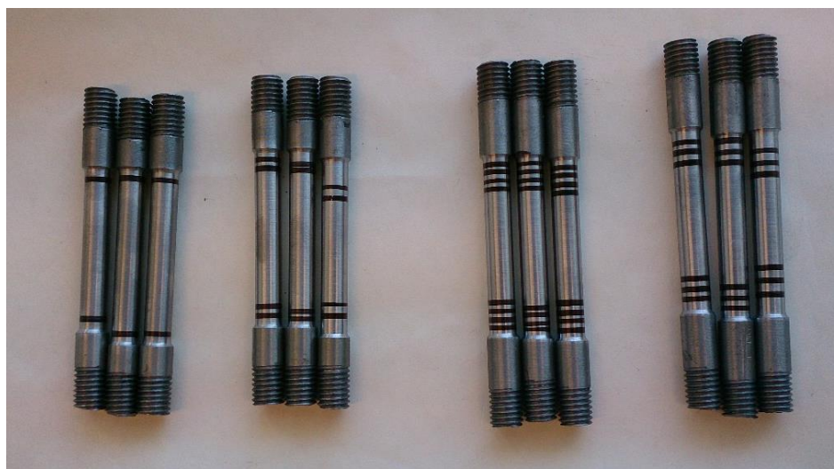
Fot. 3.9. Próbki do badań parametrów materiałowych stali w statycznej próbie rozciągania
