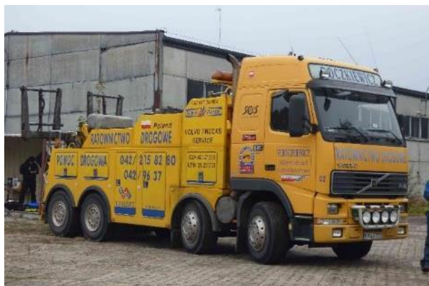
Fot. 3.5. Holownik służący do generowania obciążenia podczas eksperymentów
